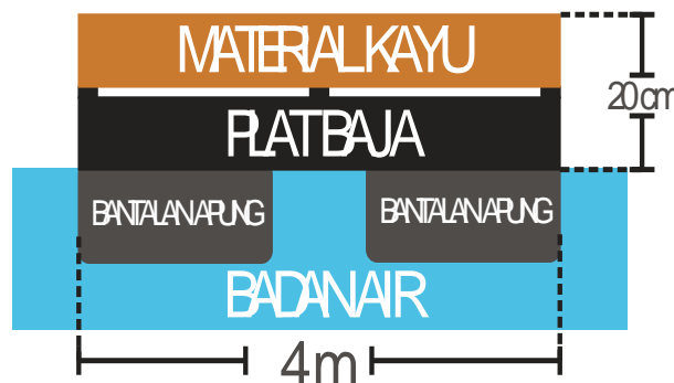
Gambar 14. Model Jembatan Penyeberangan Dermaga (Sumber: Peneliti, 2016)
