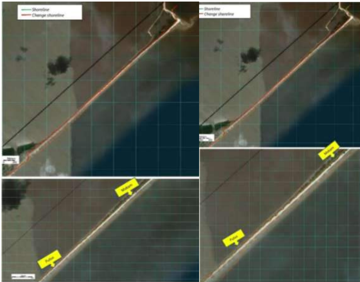
Gambar 10. Hasil simulasi selama 1 tahun dan 3 tahun model perubahan garis pantai saat posisi HWS di Prioritas 1 Skenario 1 sampai ke daerah makam.
