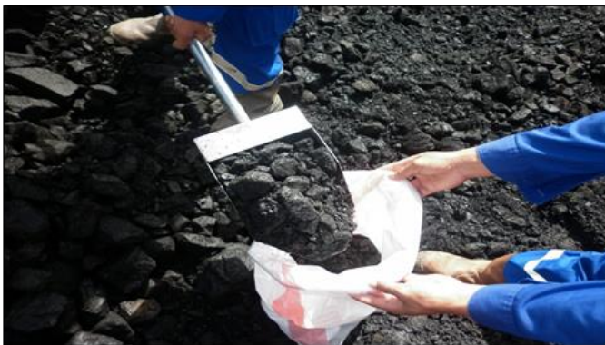
Gambar 4. Pengambilan sampel batubara pada ship loading .
