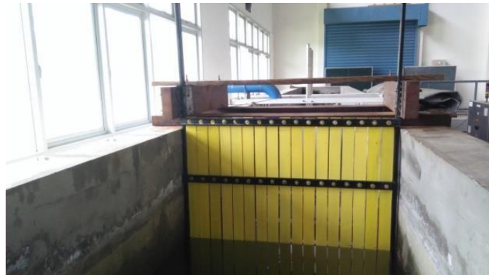
Gambar 2. Model yang telah diletakkan di dalam flume
