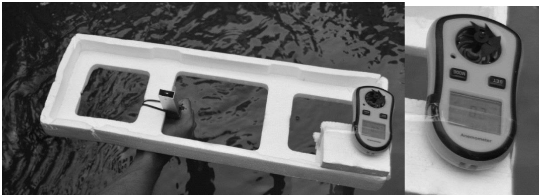
Gambar 3. (a) Pengujian alat ukur arus air, (b) display menunjukkan kecepatan arus, diperbesar
